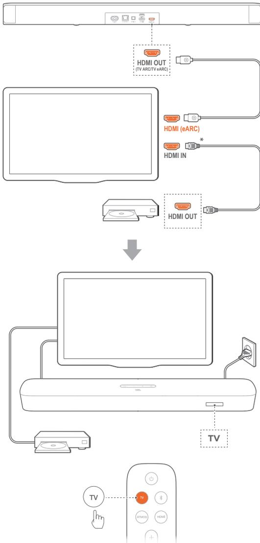
1. Verbinde die Soundbar über das mitgelieferte HDMI-Kabel mit dem Anschluss **HDMI IN (eARC)** an deinem TV-Gerät.
