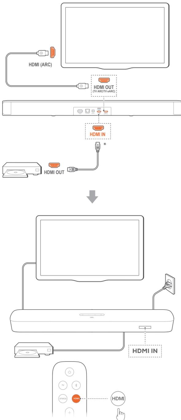
1. Schließe die Soundbar mit dem mitgelieferten HDMI-Kabel über den HDMI IN (ARC)-Anschluss an dein TV-Gerät an.
