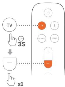
2. Drücke innerhalb von fünf Sekunden auf der Fernbedienung **+** oder **-**, um zwischen den Basspegeln umzuschalten.
