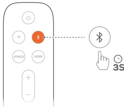
1. Halte bei aktiver Bluetooth-Quelle auf der Soundbar  $\mathbb{G}$  oder auf der Fernbedienung  $\mathbb{B}$  gedrückt, bis „BT PAIRING“ angezeigt wird.
